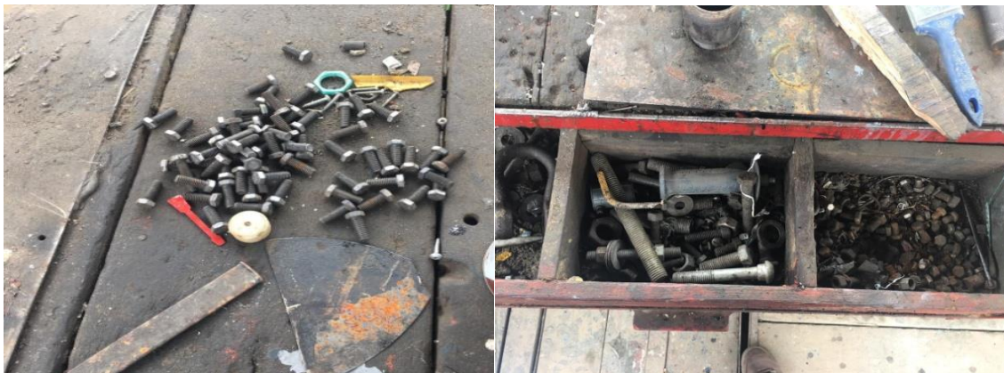
Fotografías 7 & 8: fotografías tomadas en el área de mantenimiento tornillos sin clasificar.
