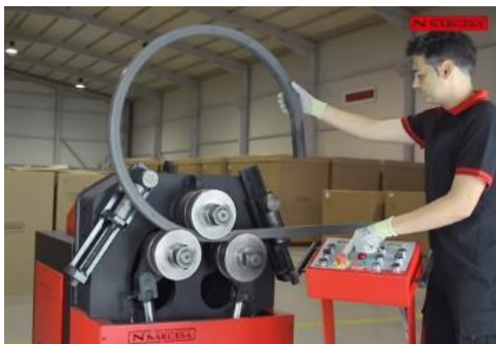
Figura 73. Máquina doblado propuesta.
