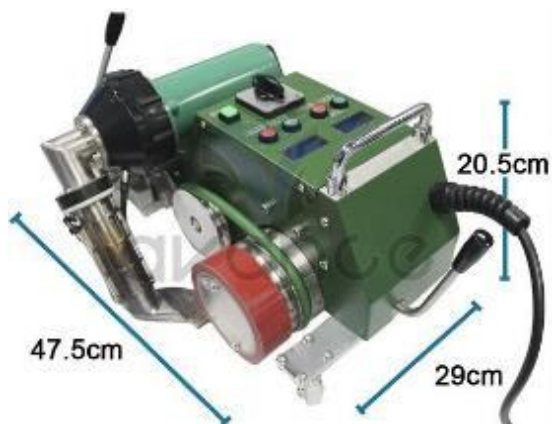
Figura 77. Maquina vulcanizadora propuesta 1.
