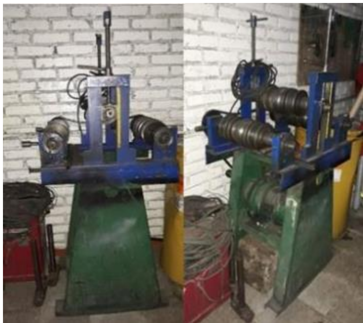
Figura 72. Máquina doblado actual.
