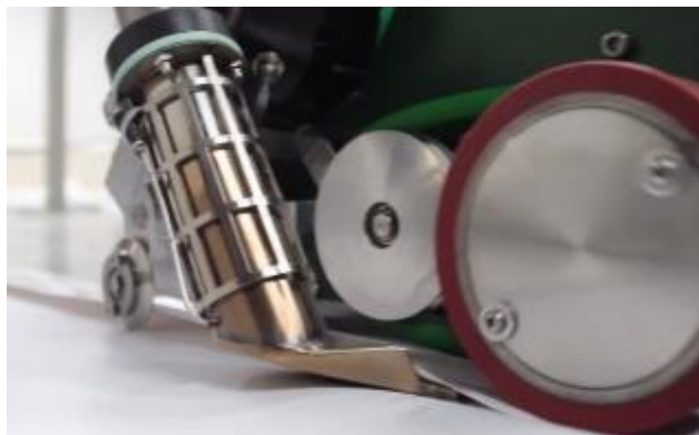
Figura 78. Maquina vulcanizadora propuesta 2.
