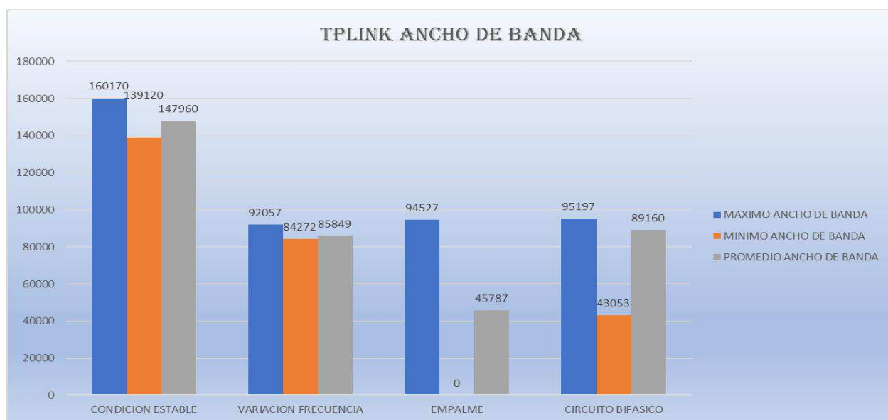
Figura 54 Comparación de las redes implementadas con dispositivos PLC TPLINK con los diferentes entornos eléctricos en ancho de banda
