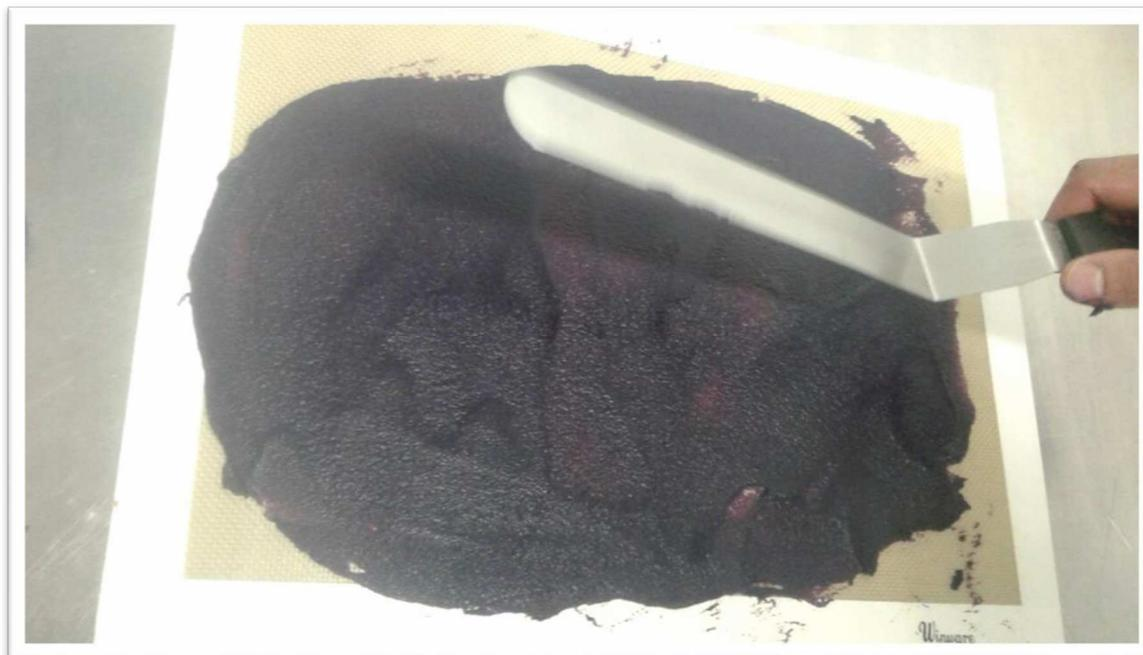
Ilustración 26. dispersión de pasta sobre tapete siliconado, para hornear a 100°C sin humedad durante 20 min.
