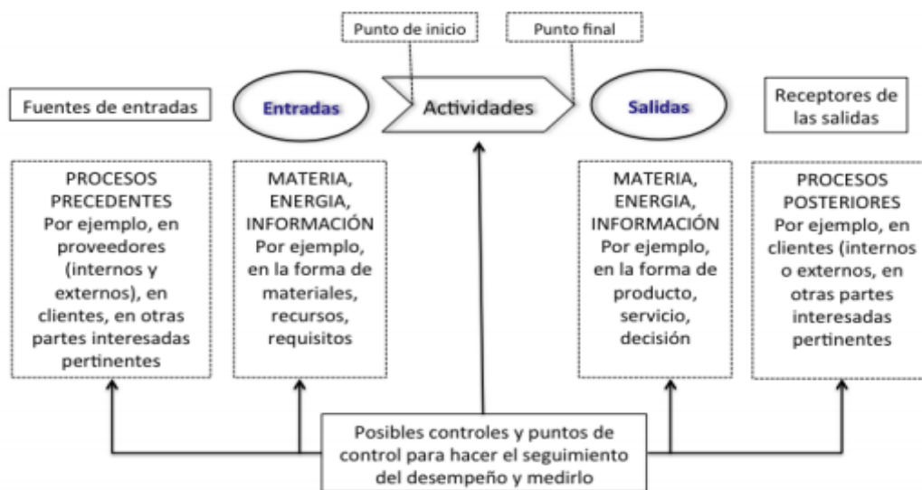
Figura 15. Diagrama elementos de un proceso ISO 9001:2015
