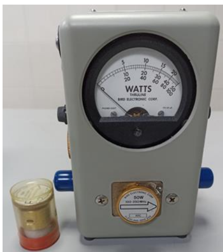
Figura 61. Medidor de Potencia BIRD SERIES 43, autoría propia.
