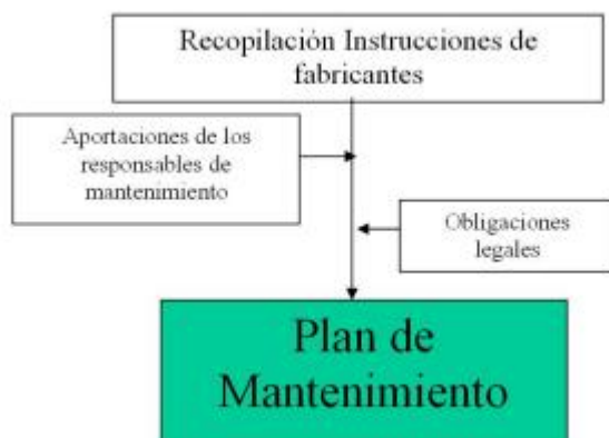
Figura 6. Fases de mantenimiento basado en instrucción de los fabricantes (Garrido, 2003).
