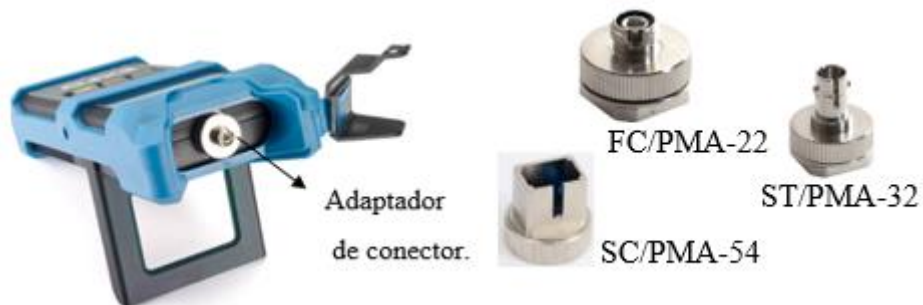
Figura 27. Posición de adaptador de conector en EPM-50 y adaptadores compatibles, autoría propia.
