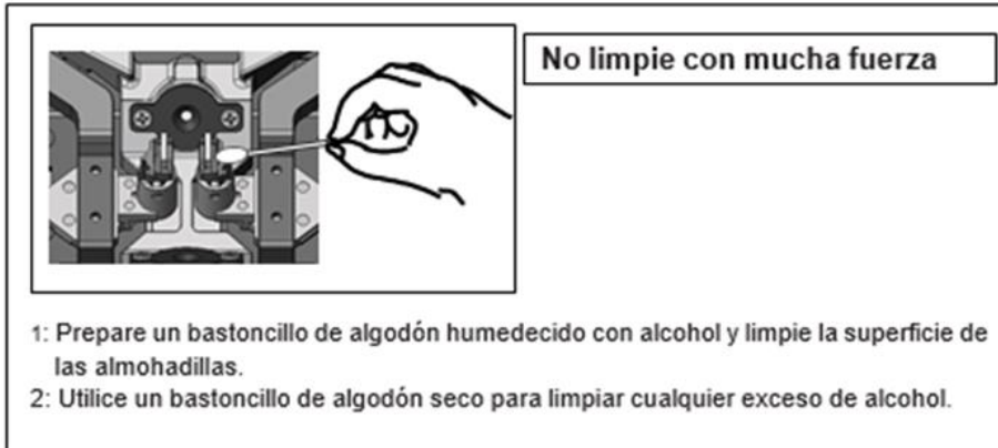
Figura 42. Limpieza de las almohadillas de fibra óptica (Sumitomo Electric Industries Ltd., 2012).
